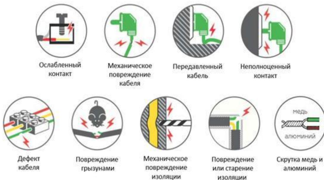
Рисунок 6. Возможные причины искрения в электропроводке
